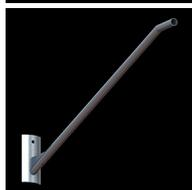
Soporte brazo 1,5 m 20°/0° para luminaria con platina curva soldada al tubo para poste tipo EPM (se sujeta al poste por medio de 1 perno). Basado en norma EPM RA5-103, para luminaria de 150,250 y 400 W, en cualquier diámetro y espesor de tubo, según figuras norma EPM o bajo cualquier diseño, galvanizado en caliente.
